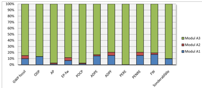
Abb.1: Relative Anteile der Module A1–A3 am Einfluss auf die Umweltwirkungsindikatoren und den Primärenergieeinsatz (cradle-to-gate)
